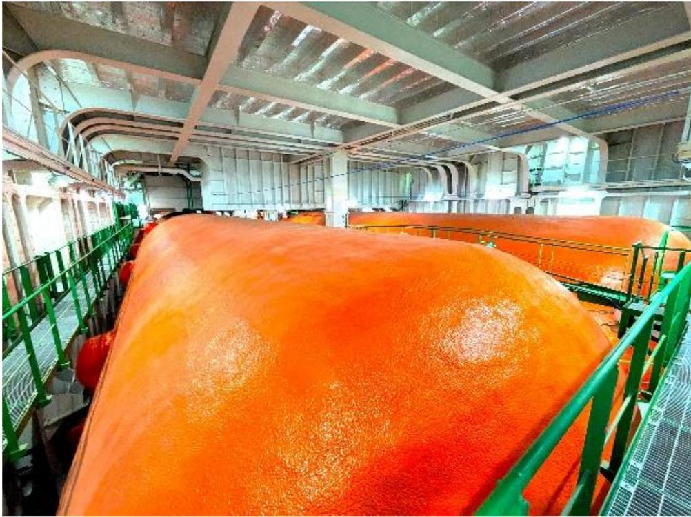
LNG 燃料タンク（写真手前と奥の2基のタンクを搭載）
